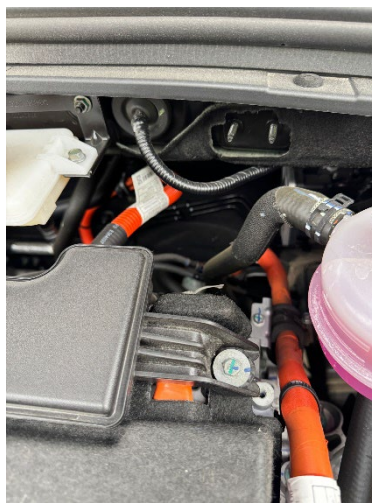
Figura 2. Cableado interior motor coche híbrido.
